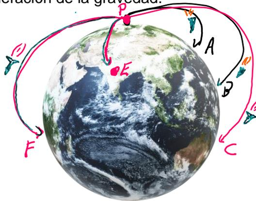
Figura 16. Lanzamiento de proyectil.
