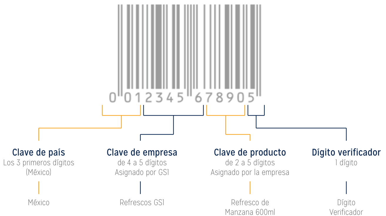
Figura 3. Estructura del código de barras. Fuente: Recuperado de http://www.softseti.net/blog/wp-content/uploads/2014/11/gtin13-e1415749007424.png
