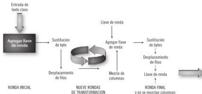
Funcionamiento del sistema de cifrado AES. Fuente: (Baca Urbina, 2016)
