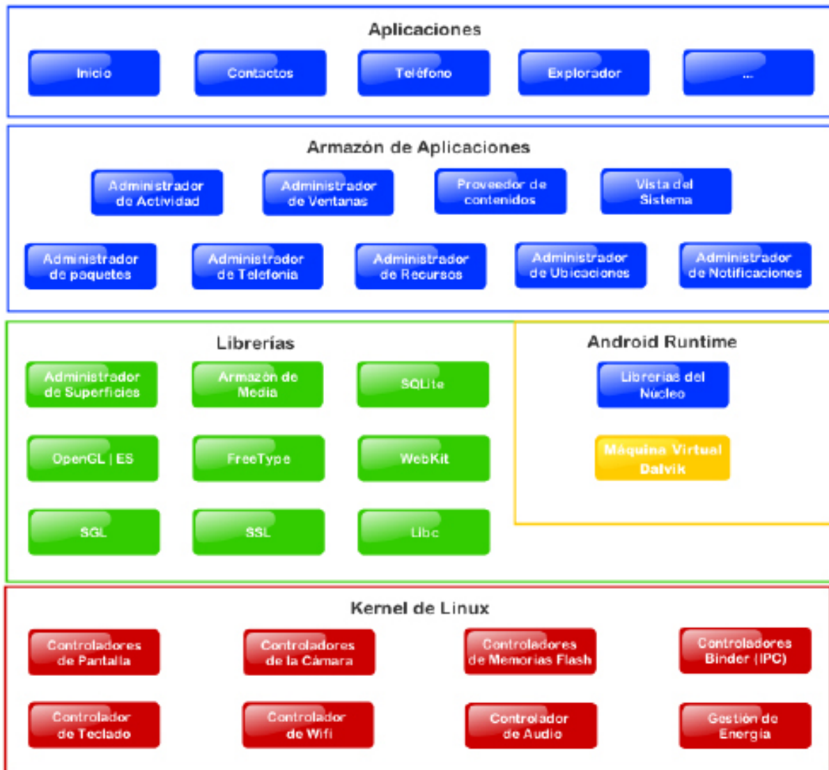
Figura 5. Estructura de Sistema Operativo Android Fuente: https://upload.wikimedia.org/wikipedia/commons/1/13/Diagrama_android.png
