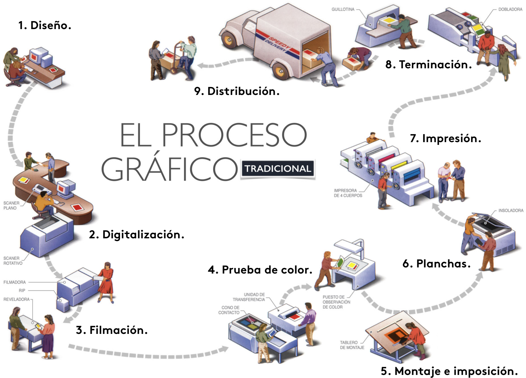
Figura 5. Gráfica de un proceso (Sistema de impresión offset) Fuente: https://www.marcelobraz.com.ar/wp-content/uploads/2020/03/proceso-grafico-1920.jpg
